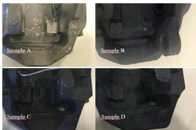
Figura 5: Resultados das Amostras A, B, C e D depois de submetidos ao teste NSS por 800 horas, de acordo com a ISO 9227.
