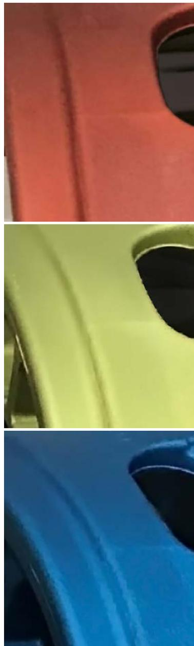
Figura 6: Liga A356, novo processo de pré-tratamento por imersão somado ao novo aditivo orgânico para solução de anodização de ácido sulfúrico para melhor penetração e desempenho do corante orgânico. Visualiza-se perfeita homogeneidade na cor. ▲
