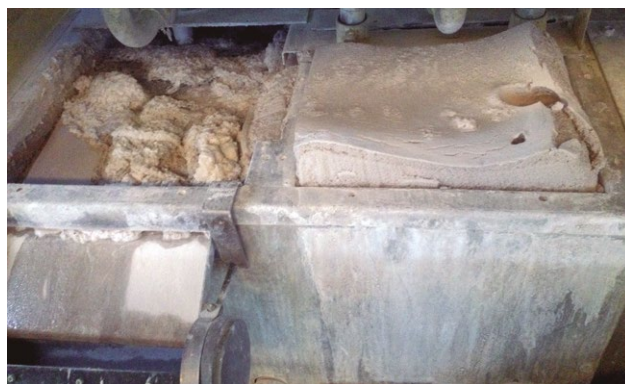
Figura 3 - O uso de desengraxante alcalino sólido leva à formação de espuma extrema
