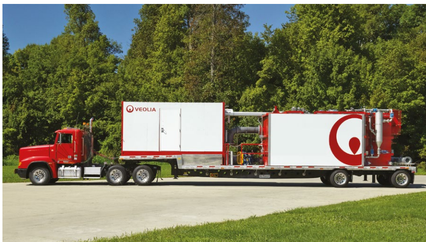
A unidade remove sólidos suspensos, cor, algas, metais e outros poluentes, e pode alcançar uma vazão de 70 m 3 /h a 340 m 3 /h, tratando águas com turbidez maior que 1.000NTU
