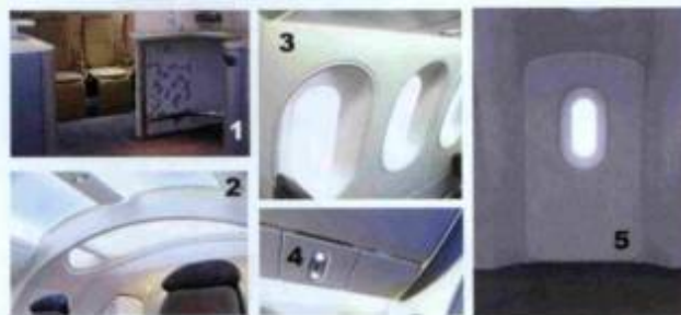
Figura 2: Alguns itens de um salão de passageiro de aviões fabricados de plástico reforçado pintado: 1: Mobiliário; 2: Revestimentos laterais e de teto; 3: Máscaras de janelas; 4: Sancas; 5: Revestimentos de portas 4
