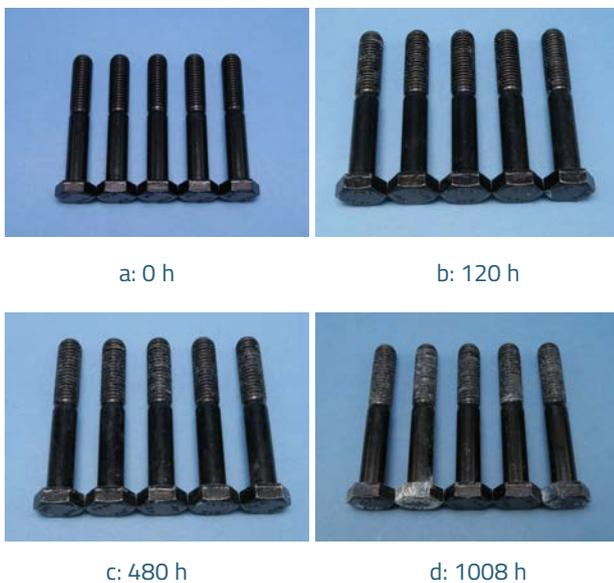
Após 120 horas de ensaio de névoa salina (EN ISO 9227), os parafusos passivados pretos mostram apenas uma leve corrosão branca, à medida que os parafusos
