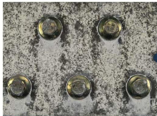
Figura 18: Zinco alcalino + passivador + selante inorgânico reativo, 6 ciclos Ford L-467, sobre a chapa com KTL
