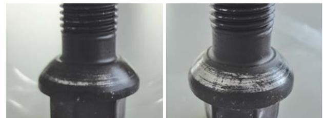
A função de barreira dos *top coats* de 8 µm em combinação com a alta resistência à corrosão branca de uma camada de zinco-níquel pode atingir >1008 h em NSST (EN ISO 9227) (Figura 11).
