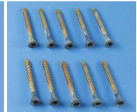
Figura 20c: Galvanizado a fogo, 8 ciclos
