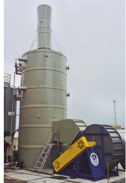
Lavador de gases e ventilador centrífugo
