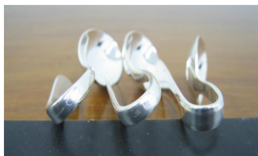
Figura 13 – 3 colheres de aço inoxidável prateadas após realteração do processo
