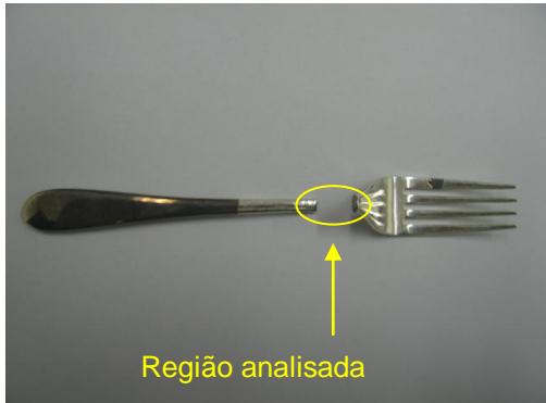
Figura 1 – Garfo com problema de descascamento (lote devolvido)
