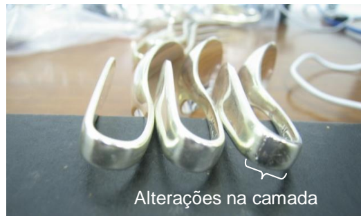
Figura 11 – Colheres de aço inoxidável prateadas pelo processo novo (após alterações sugeridas pelo PRUMO/TS)
