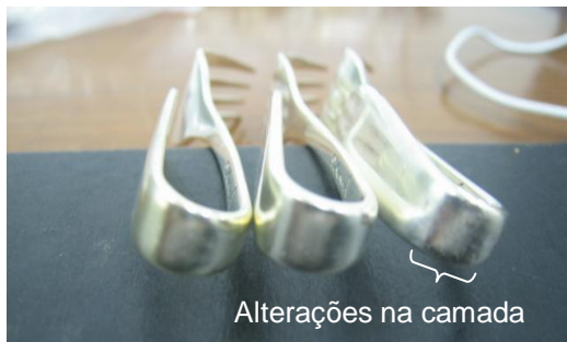
Figura 10 – Garfos de aço inoxidável prateados pelo processo novo (após alterações sugeridas pelo PRUMO/TS)
