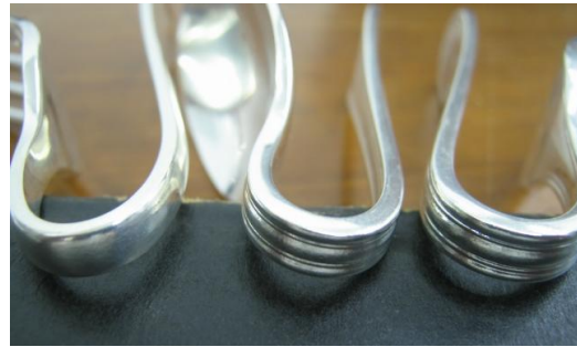
Figura 9 – Talheres de aço inoxidável prateados pelo processo novo (após alterações sugeridas pelo PRUMO/TS)
